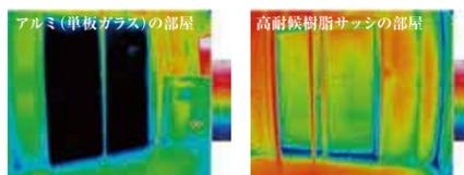
アルミ(単板ガラス)の部屋    高耐候樹脂サッシの部屋
