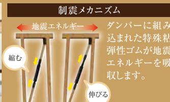
※当社モデルプランにおける地震応答解析結果による変形抑制効果。建物形状、配置プラン、地震波等によって異なります。
